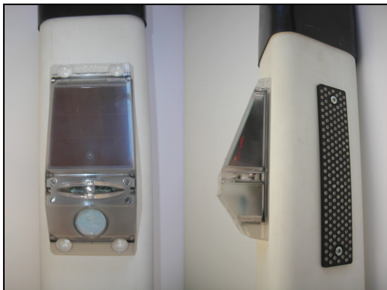
Abb. 11: Aufsicht (links) und Seitenansicht (Mitte) des akustischen Wildwarners Typ „Wiwasol“. Die unterschiedlichen Varianten sind äußerlich kaum zu unterscheiden. (Fotos: W. Steiner)
